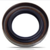
RETENTOR DUCATO 97/22 LATERAL COROA LD 34,9X54X8,5 - IMP ITALIA (SOB AMOSTRA)
